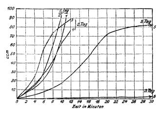
(Kurve 5). 6 Stdn. später war fast vollständige Lähmung des Palladiumhydrosols eingetreten, denn als nun die Wasserstoff enthaltende Schüttelente wieder mit der Sauerstoffbürette verbunden und Sauerstoff in erstere hinübergedrückt worden war, verschwanden in 65 Minuten nur 1.6 ccm Gas (Kurve 6), worant Volumkonstanz eintrat.
